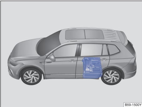
图 186 高压电池的安装位置：位于汽车后排座椅下方
