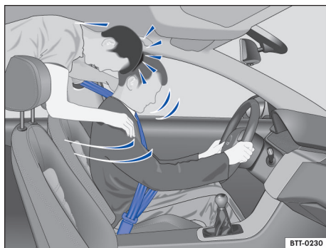
图 31 未系安全带的后排乘员被猛烈前抛，撞击佩戴安全带的驾驶员
