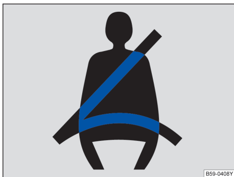
图 27 安全带未系警告灯
